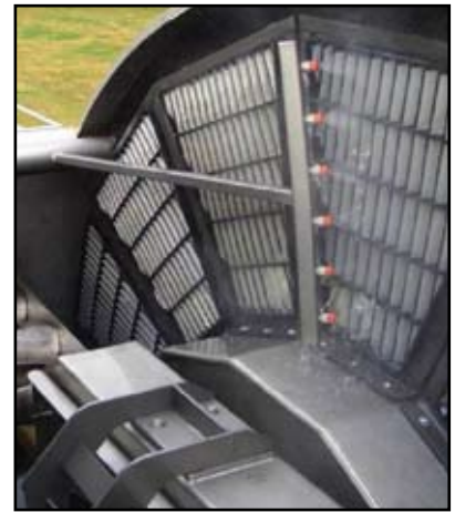
Figura 4. El mecanismo de inyectores de contralavado está especialmente diseñado para una remoción eficiente de los sólidos de los paneles plisados.
