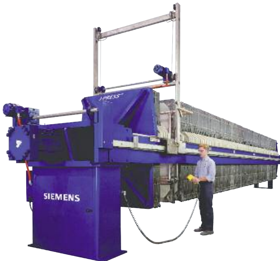
1,5 x 2,0 m Filtro-prensa Totalmente automático con lavador de telas automático.
