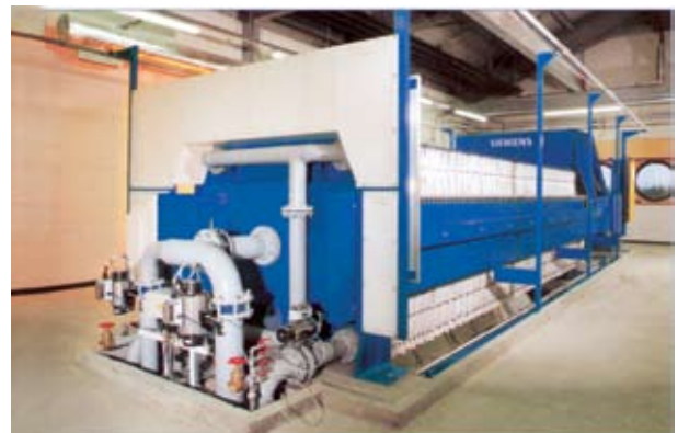
带自动滤布清洗机的1500mm全自动型。
